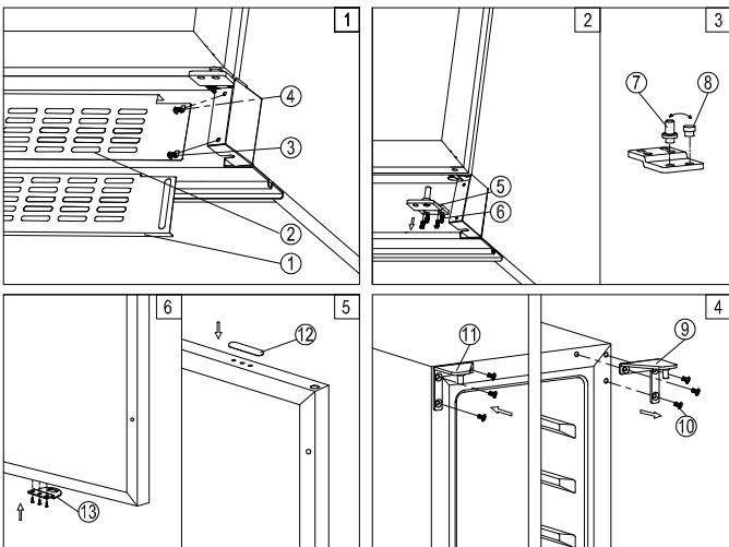
1. Entfernen Sie die Lüftungsgitter ② und die einstellbare Lüftungsgitter ① durch Lösen der Schrauben ③ & ④. (Fig. 1)
