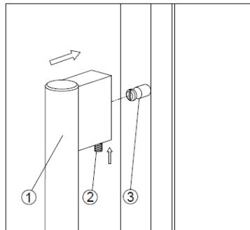
Positionieren Sie den Türgriff (1) gegenüber den Türachsen (3) und ziehen Sie die Schrauben mit einem Inbusschlüssel (2) fest.
