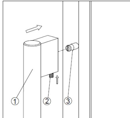
1. Positionnez la poignée (1) face aux axes de la porte (3) et serrez les vis à l'aide d'une clé Allen (2).
