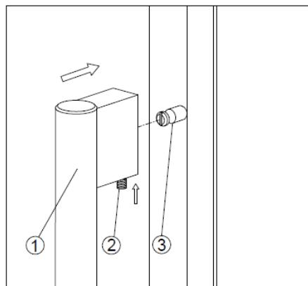
Posicione el tirador (1) frente a los ejes de la puerta (3) y apriete los tornillos con una llave Allen (2).
