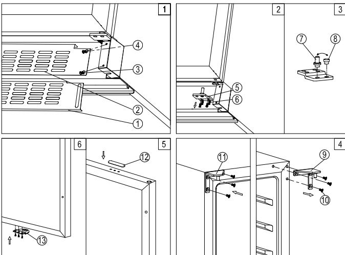
1. Verwijder het ventilatierooster ②, 2 en de verstelbare ventilatierooster ① door de schroeven ③ & ④, 4. (Fig. 1)
