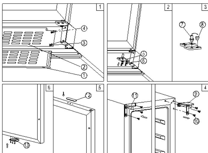
1. Retire la rejilla de ventilación ○, 2 y la rejilla de ventilación regulable ○, 1 aflojando los tornillos ○, 3 & ○, 4. (Fig. 1) NOTA: Para algunos modelos sin rejilla de ventilación regulable, no se necesita el paso.
