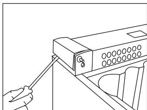
4. Démonter avec précaution les plaques qui recouvrent les côtés du socle, à l'aide d'un tournevis plat à rainure.
