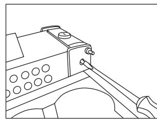
6. Den Schlossriegel mit einem flachen Schraubendreher losschrauben.
