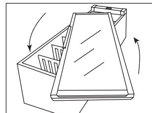
3. Die Glästüre umdrehen (beim FZ 295 W den Handgriff abnehmen, der innen unter der Dichtleiste zu lösen ist).
